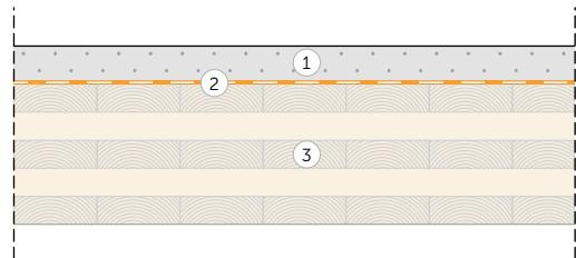
Dank Hinzufügen des schwimmenden Estrichsystems auf dem unbehandelten BSP.
